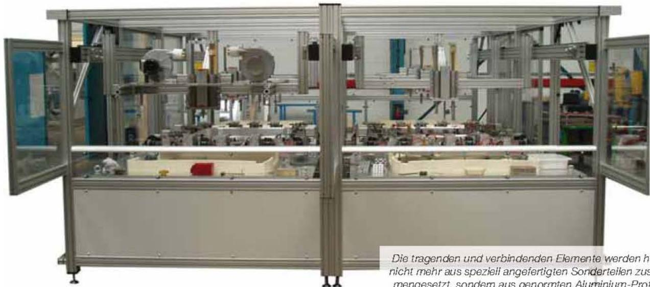
Die tragenden und verbindenden Elemente werden heute nicht mehr aus speziell angefertigten Sonderteilen zusammengesetzt, sondern aus genormten Aluminium-Profilen.
