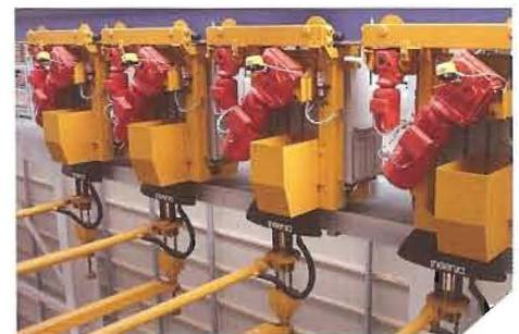
Mittels Frequenzumrichter stufenlos gesteuerte fahrerlose Transporteinheiten mit lastabhängiger Hubwerksregelung verkehren nicht nach Fahrplan, sondern ereignisgesteuert.
