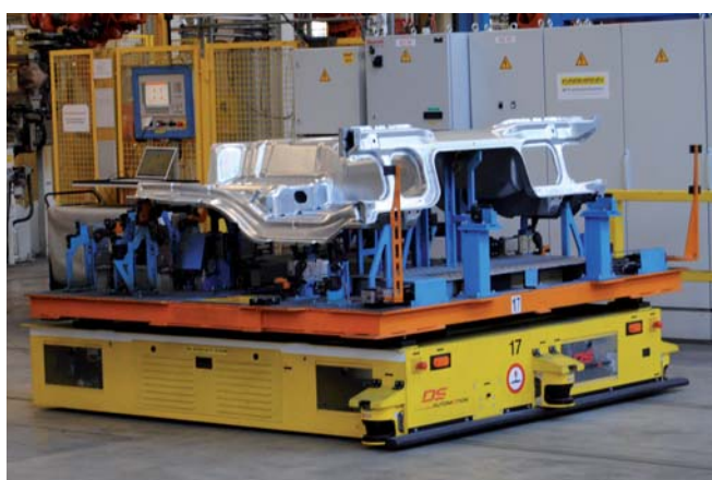
Die 8 Fertigungszellen der Fahrerhaus-Rohbauproduktionsanlage sind mit automatischen fahrerlosen Transportsystemen verbunden.
