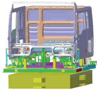
Ab 2008 wurde der gesamte Produktionsablauf für den Fahrerhaus-Rohbau in Plant Simulation abgebildet.
