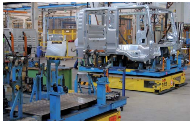
Konkrete Einsparung durch Verzicht auf die Anschaffung einer zusätzlichen Spannvorrichtung für die Fahrerhausfertigung
