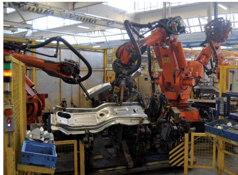
In solchen Roboterzellen mit drei Knickarmrobotern werden in Steyr mehrere hundert Bodengruppen von LKW pro Tag geschweißt.
