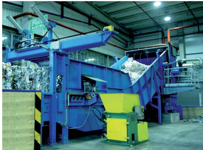
Mit mehreren 10.000 Einzelteilen und Baugruppen nur ein kleiner Teil einer Gesamtanlage: FMW-ALTPAPIERENTDRAGUNGSANLAGE EXTRACTOR für die Entbündelung von bis zu 180 Ballen Altpapier pro Stunde
