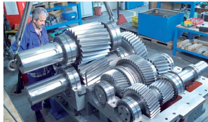
Montage eines Kammwalzgetriebes für die Stahlindustrie
