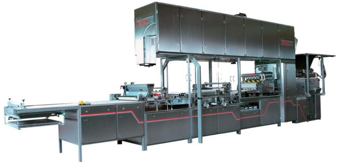
Oberes Ende des Produktspektrums: Grubelnik-Anlagen für die industrielle Fertigung von stündlich bis zu 36.000 Stk. Kleingebäck
