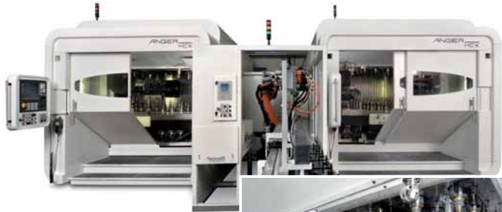
Komplexer Bearbeitungsprozess mit zwei Anger HCX- Anlagen und Roboterbeladung für einen führenden Automobilkonzern.
