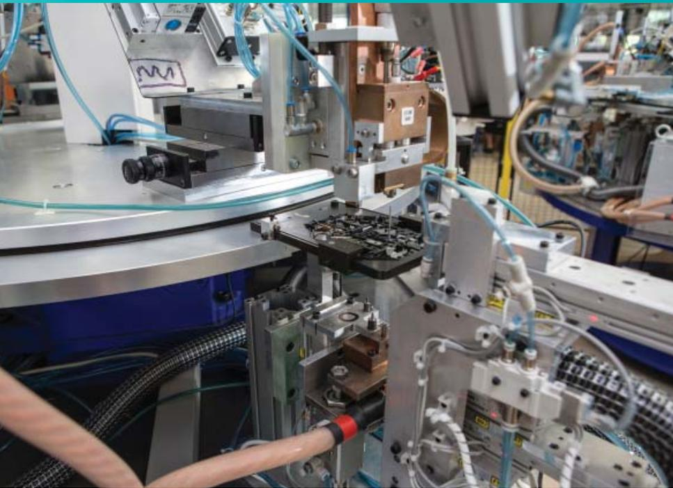
*Pollmann entwickelt und baut maßgeschneiderte Lösungen von assistierten Handarbeitsplätzen bis zu hoch komplexen Spritzgießanlagen mit integrierten Prüf- und Montagefunktionen.*
