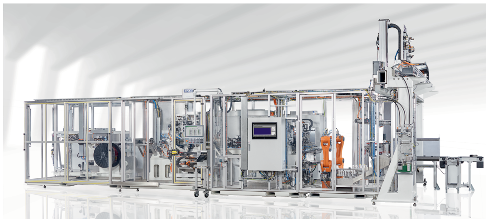
GROB ist ein führender Hersteller von Werkzeugmaschinen und Produktionsanlagen für die Automobilindustrie. Das Bild zeigt eine Maschine für die Statorfertigung mit Hairpin-Technologie. (Alle Bilder: GROB)
