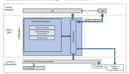
Opcenter Execution Process agiert als Informationsdrehscheibe zwischen der ERP-Software und dem Prozessautomationssystem. Zusätzlich kommuniziert es mit dem Laborinformations-Managementsystem und für Probennahme, Materialverfolgung und Verpackung mit drahtlosen Handgeräten.
