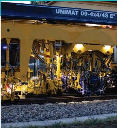
Kern der Gleisstopfmachine sind vibrierende Stopfpickel, die nach einem von Plasser & Theurer 1953 erfundenen Verfahren den Gleisschotter unter die Schwellen stopfen und so ein stabiles Gleisbett schaffen.
