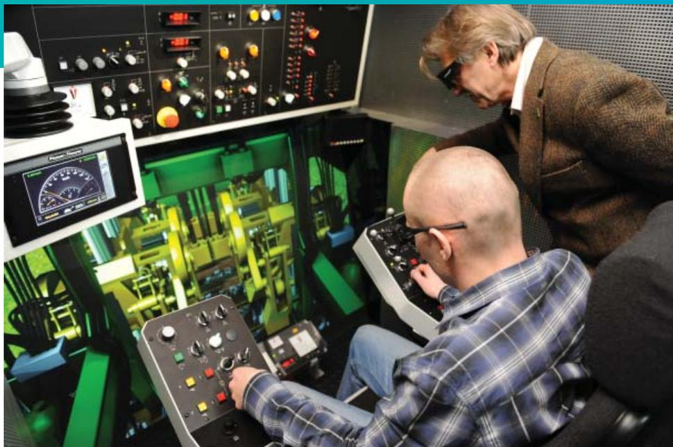
Plasser & Theurer nutzt den in Solid Edge erzeugten digitalen Zwilling seiner Gleisbaumaschinen für Bedienschulungen im Mixed-Reality-Simulator.
