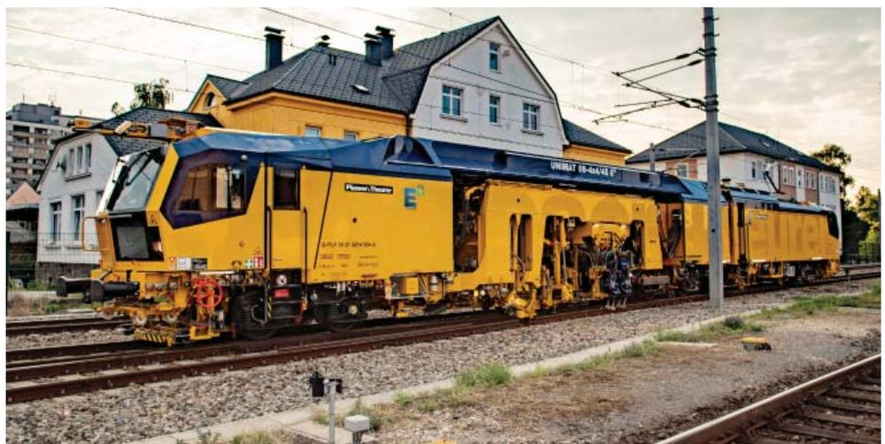
Die Unimat 09-4x4/4S E<sup>3</sup> von Plasser & Theurer ist die weltweit erste Universal-Gleisstopfmaschine mit Hybridantrieb. Gegenüber ihren dieselbetriebenen Vorgängermodellen reduziert dieser wesentlich Lärmentwicklung und Kosten von Erneuerungsarbeiten. Alle Bilder: Plasser & Theurer.
