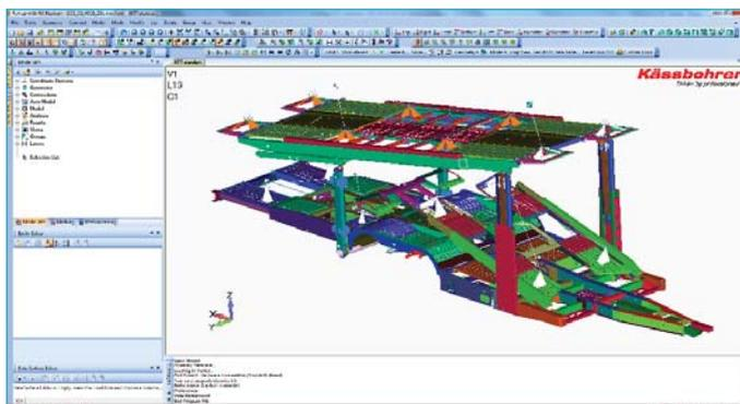
In der Software Femap mit NX Nastran erfolgen auf Basis von Flächenmodellen aus Solid Edge Festigkeits- und Belastungsprüfungen mittels Finite Elemente Analyse.
