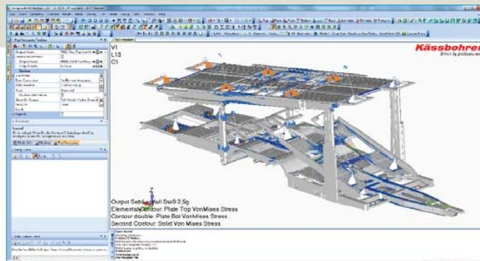
Abgesichert durch die Festigkeitsprüfung mit Femap konnten die Entwicklungsingenieure bei Kässbohrer Transport Technik durch relativ kleine konstruktive Anpassungen des Lade-Plateaus von hochfestem Stahl auf ein Material umstellen, das deutlich kostengünstiger und zudem leichter zu bearbeiten ist.
