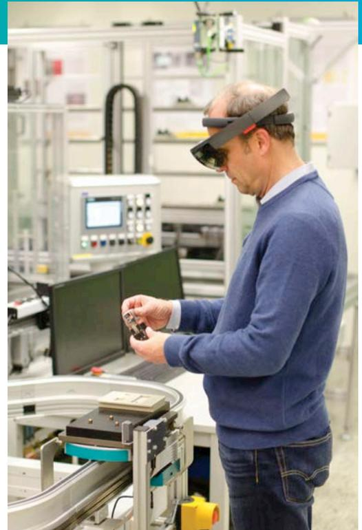
*Bei der Endkontrolle durchgefallene Relais werden zu einem Handarbeitsplatz transportiert. Die dort arbeitenden Werker werden bei der Fehlerbehebung durch in VR-Brillen angezeigte 3D-Animationen und Anleitungen unterstützt.*
