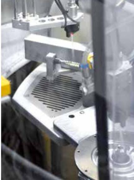
**Die zweite JetModul-Düseneinheit sitzt auf einer Linearachse und reinigt das Einsteckritzel.**
