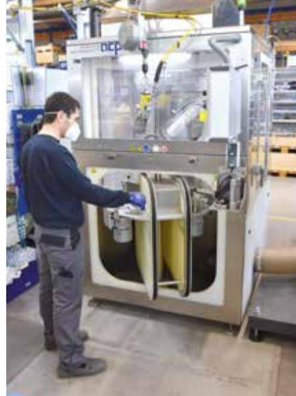
**Die doppelte Ausführung der Aufnahmen für Motor und Ritzel an einer Drehtür ermöglicht die hauptzeitparallele Beschickung und Entnahme der Teile.**
