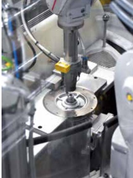
**Eine der beiden quattroClean-Ringdüsen ist auf einem Sechssachs-Knickarmroboter angebracht.**
