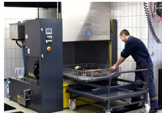
In Puch-Urstein bei Salzburg betreibt Scania Österreich einen Wartungsstützpunkt. Die Reinigung der Metall- und Kunststoffteile aus Motor, Getriebe oder Fahrwerk der Schwerfahrzeuge zur Reparaturvorbereitung erfolgt auf einer über die MAP PAMMINGER GMBH bezogenen 1-Bad-Anlage BUPI CLEANER® Powertec Basic 4 der BUPI Golser Maschinenbau GmbH.
