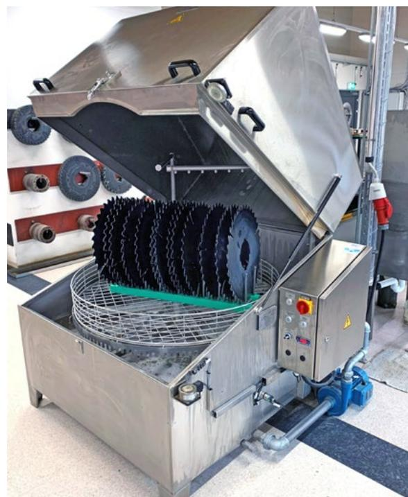
Die Reinigung der Werkzeuge erfolgt in einem Render WE 115 mit 1.150 mm Korbdurchmesser. Die zu reinigenden Sägen und Segmente werden dazu auf ein selbst gebautes Aufnahmegestell geschichtet. Die rotierenden Werkzeuge werden gleichzeitig von vertikal angeordneten Punktstrahldüsen und von Fächerdüsen in einem horizontalen Düsenstrang besprüht
