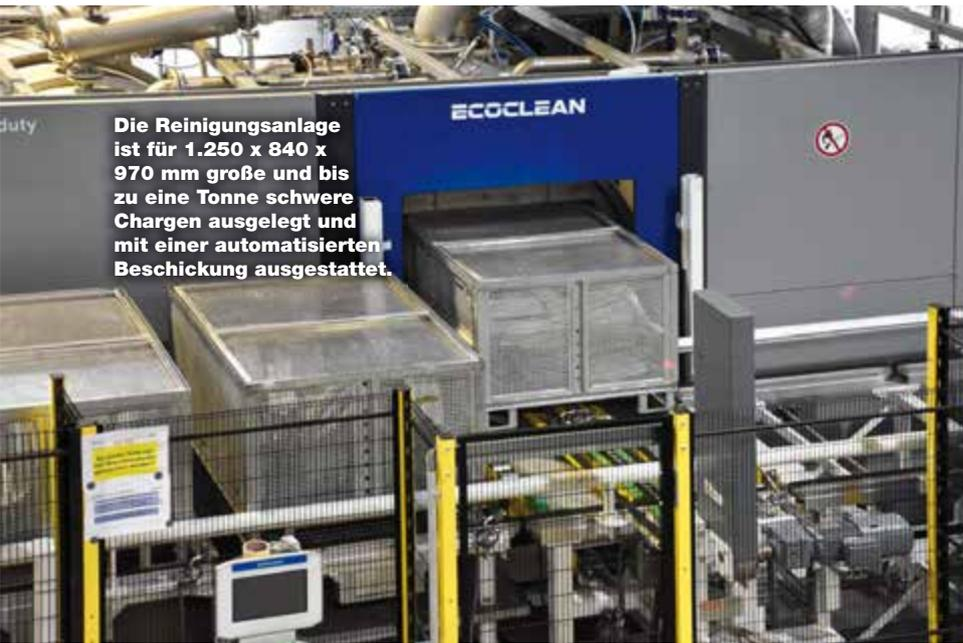
Die Reinigungsanlage ist für 1.250 x 840 x 970 mm große und bis zu eine Tonne schwere Chargen ausgelegt und mit einer automatisierten Beschickung ausgestattet.
