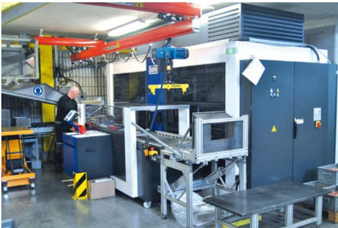
Seit Mitte 2014 werden Stanz-Biegeteile mittels Lösemittelreinigung im Vakuum in einer von MAP Pamminger gelieferten EcoCCore von Ecoclean entfettet.
