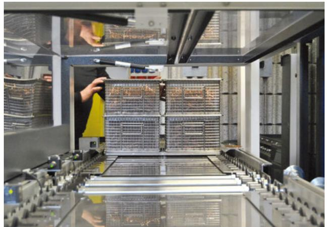
Entscheidend für die Auswahl der EcoCCore von Ecoclean war deren im Vergleich zum Mitbewerbsprodukt um mehr als ein Drittel größere Reinigungskammer.
