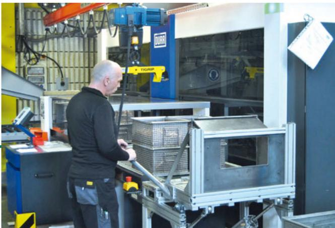
von Ecoclean. Die damals neu auf den Markt gebrachte Anlage verbindet die Vorteile einer Lösemittelreinigungsanlage mit einem durchdachten Anlagendesign und einfacher, intuitiver Bedienung durch übersichtliche Prozessverfolgung samt Teilvisualisierung. Das erleichtert dem Werkmeister das Erstellen unterschiedlicher Programme, mit denen verschiedene Produktionsmitarbeiter die Anlage nach nur kurzer Einschulung nutzen können.
