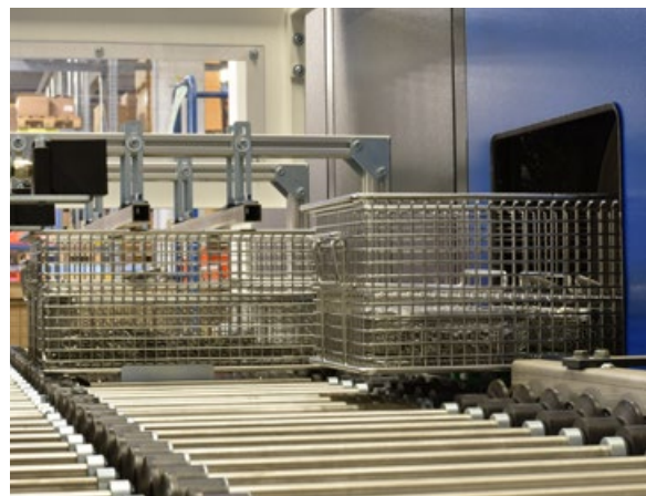
Für hohen Durchsatz sorgt die hauptzeitparallele Beschickung über eine automatische Zuführung mit drei Aufgabepätzen.
