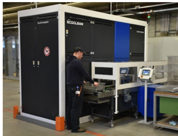
Flutreinigung im Vakuum mit modifiziertem Alkohol in einer EcoCcompact von Ecoclean sichert die Erfüllung der Reinheitsanforderungen.
