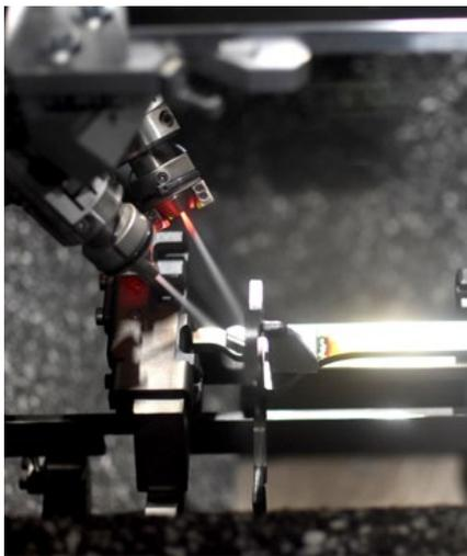
Flüssiges Kohlendioxid entspannt beim Austritt aus der Zweistoff-Ringdüse des quattroClean-Systems zu feinen CO<sub>2</sub>-Kristallen. Beim Auftreffen auf die Bauteiloberfläche mit Überschallgeschwindigkeit werden filmische und partikuläre Verunreinigungen rückstandsfrei und trocken entfernt.
