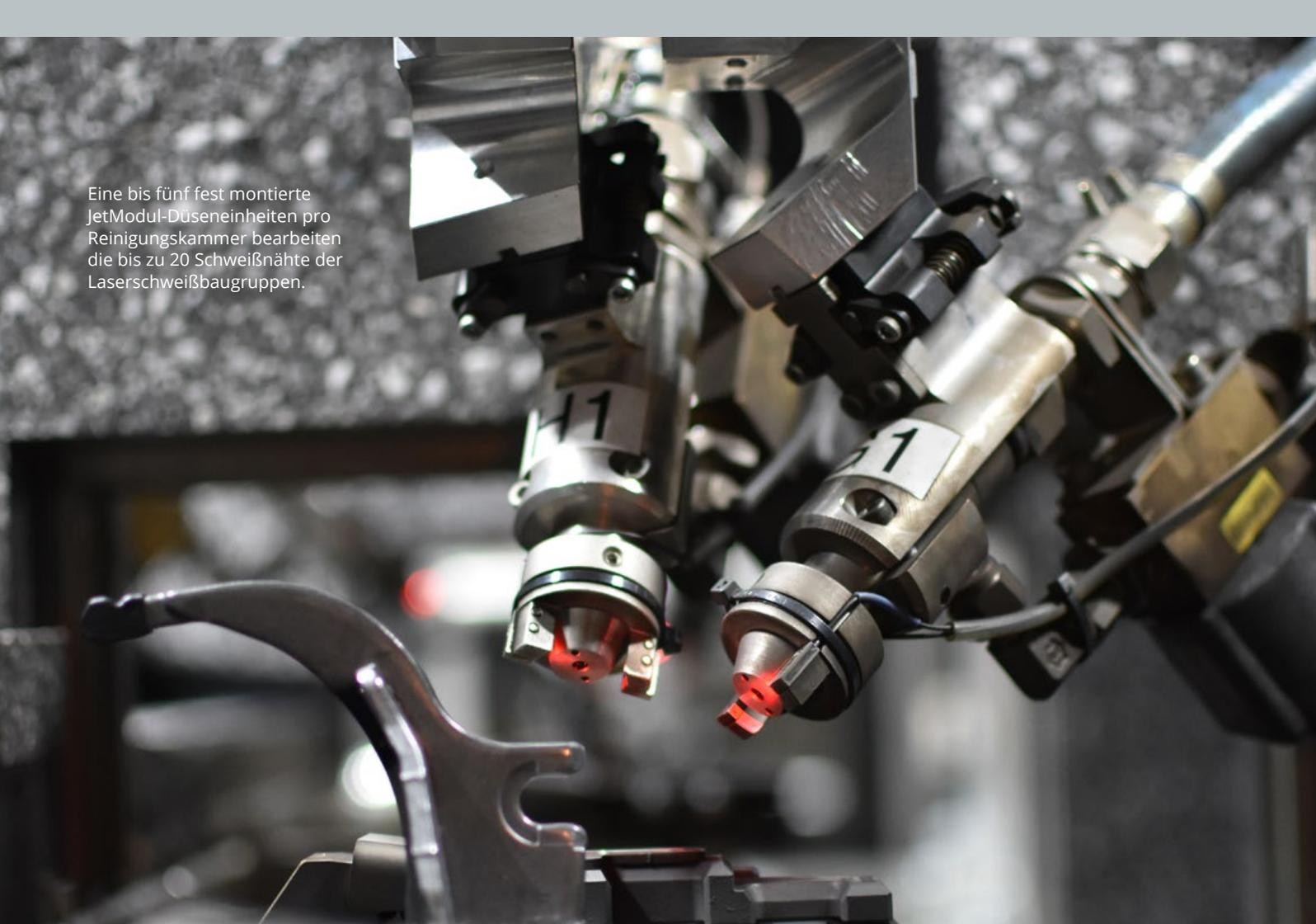
Eine bis fünf fest montierte JetModul-Düseneinheiten pro Reinigungskammer bearbeiten die bis zu 20 Schweißnähte der Laserschweißbaugruppen.
