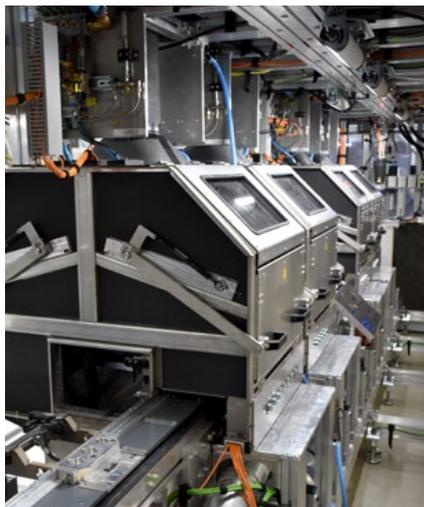
Die Reinigung erfolgt in die Fertigungslinie integriert in einer vom Schwesterunternehmen STIWA Automation entwickelten Anlage mit vier hintereinander angeordneten Reinigungskammern.
