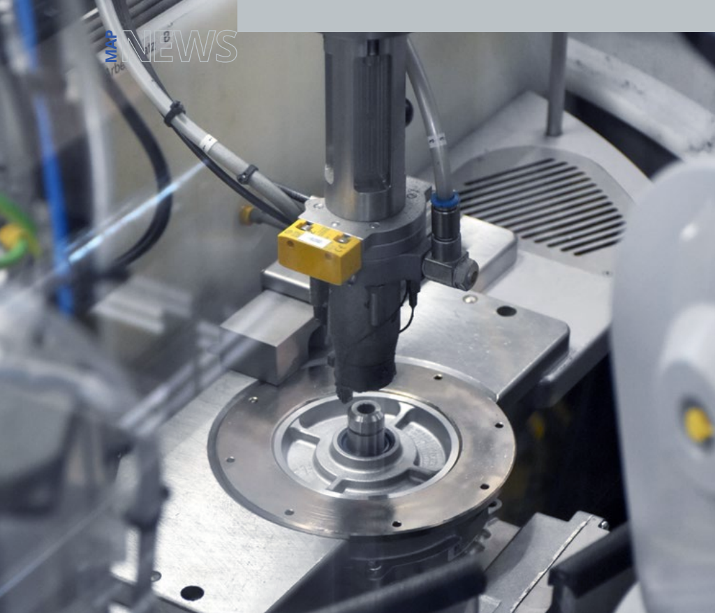
Eine der beiden quattroClean-Ringdüsen in der Reinigungsanlage ist auf einem Sechssachs-Knickarmroboter angebracht und reinigt die Welle des Motors.
