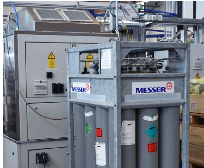
Bei der CO 2 -Schneestrahlnreinigung ist keine Reinigungschemie im Spiel, einziger Betriebsstoff ist flüssiges Kohlendioxid.
