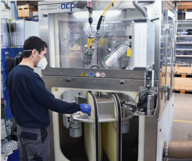
Die doppelte Ausführung der Aufnahmen für Motor und Ritzel an einer Drehtür ermöglicht die hauptzeitparallele Beschickung und Entnahme der Teile.
