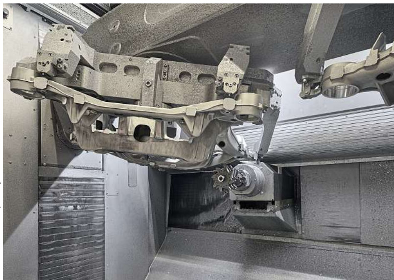
Im Zentrum der Anlage stehen drei hoch performante Doppelspindel-Bearbeitungszentren vom Typ Syncromill C21-80/1500.
