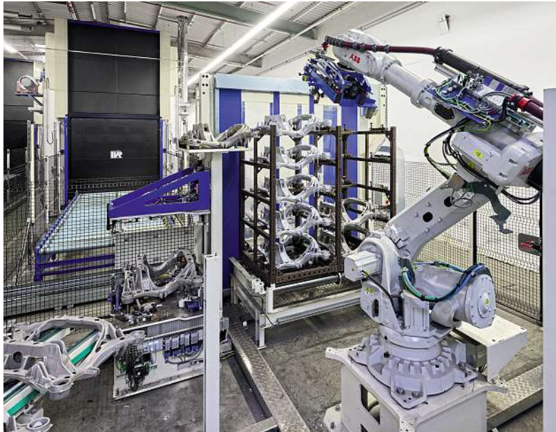
Die robotergestützte Anlagenautomatisierung beginnt mit dem Eintransport in die Wärmebehandlung.
