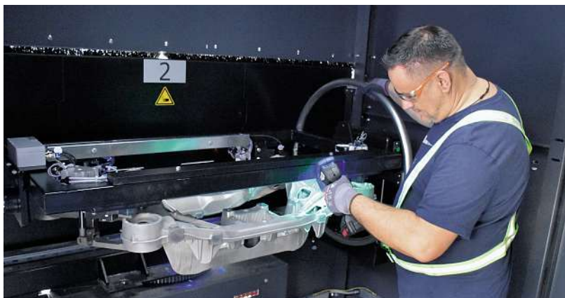
Nach der Wärmebehandlung erfolgt in zwei bemannten und einer unbemannten voll automatischen Station die Rissprüfung.
