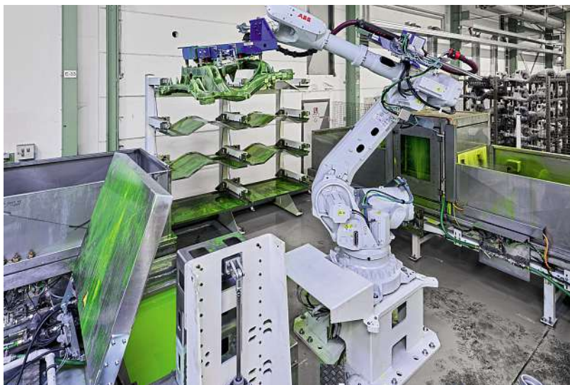
Für die Rissprüfung müssen die Teile mit einem Kontrastmittel besprüht und anschließend wieder gereinigt werden.
