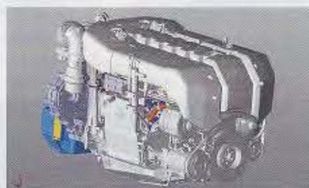
Mit EPLAN Harness proD kann der Kabelbaum parallel zur Mechanikkonstruktion vor Fertigstellung eines Prototypen entwickelt werden. Dazu können in das Programm 3D-Daten aller gängigen MCAD-Systeme importiert werden.
