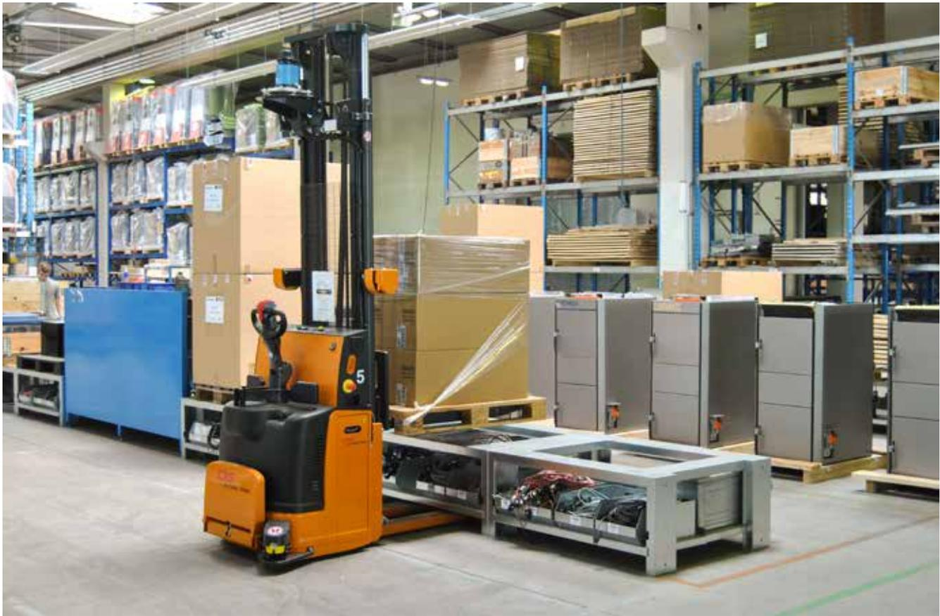
**Die fahrerlosen Hochhubwagen von DS Automotion** stellen das gesamte Vormaterial für jedes Produktionslos bedarfsgerecht an den Fertigungslinien bereit. Nicht gänzlich entleerte Behälter bringen die FTF wieder ins Lager.
