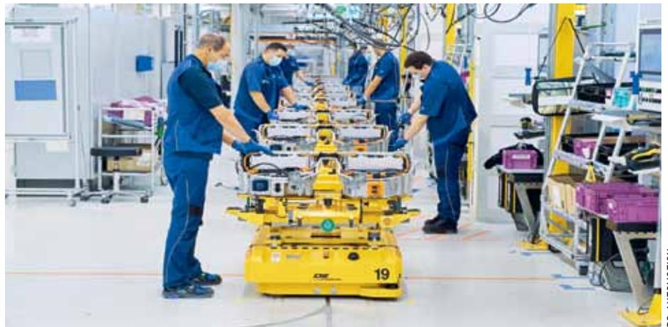
*Im größten europäischen Werk eines deutschen Premium-Automobilherstellers erfolgt der Aufbau der Batteriemodule – hier solche für Hybridfahrzeuge – auf Fahrerlosen Transportfahrzeugen von DS Automotion.*
