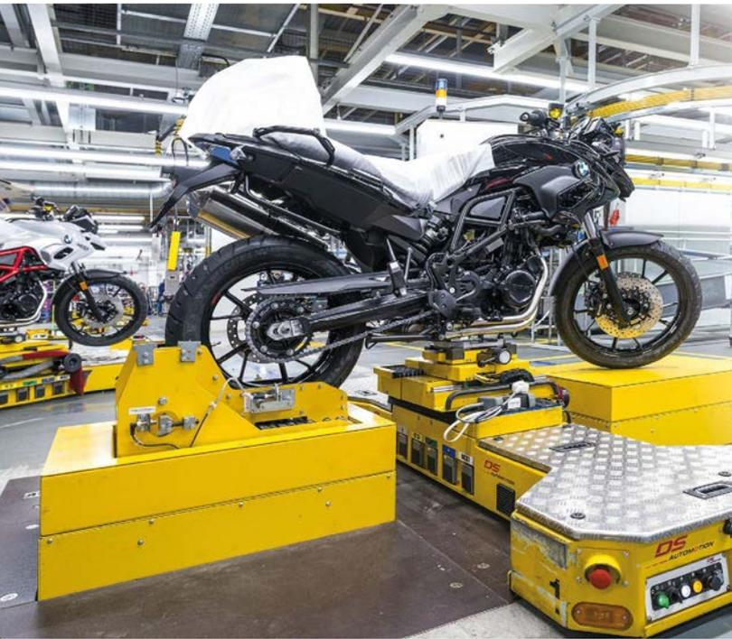
**Das Abnehmen der bis zu 400 kg schweren Motorräder von den Transportfahrzeugen vor der Ausgangsprüfung ist keine Hebeübung für die Mitarbeiter, sondern eine Aufgabe einer ebenfalls von DS Automotion gelieferten Hebestation.**
