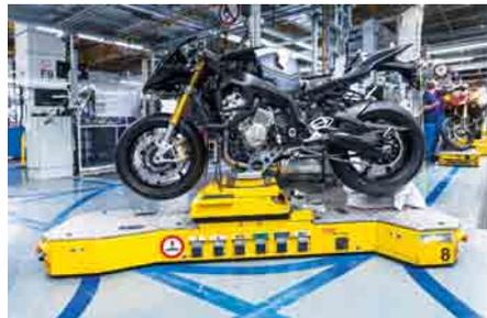
Bis zu 800 Motorräder pro Tag produziert das BMW-Werk Berlin. Die Montage der Zwei- und Vierzylindermodelle erfolgt auf einem Fahrerlosen Transportsystem.
