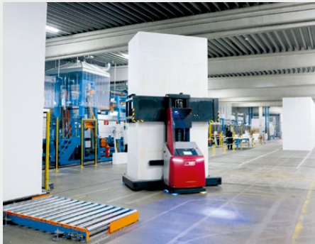
Ein Fahrerloses Transportsystem von DS Automotion transportiert rund um die Uhr Polystyrol-Hartschaum-Blöcke.
