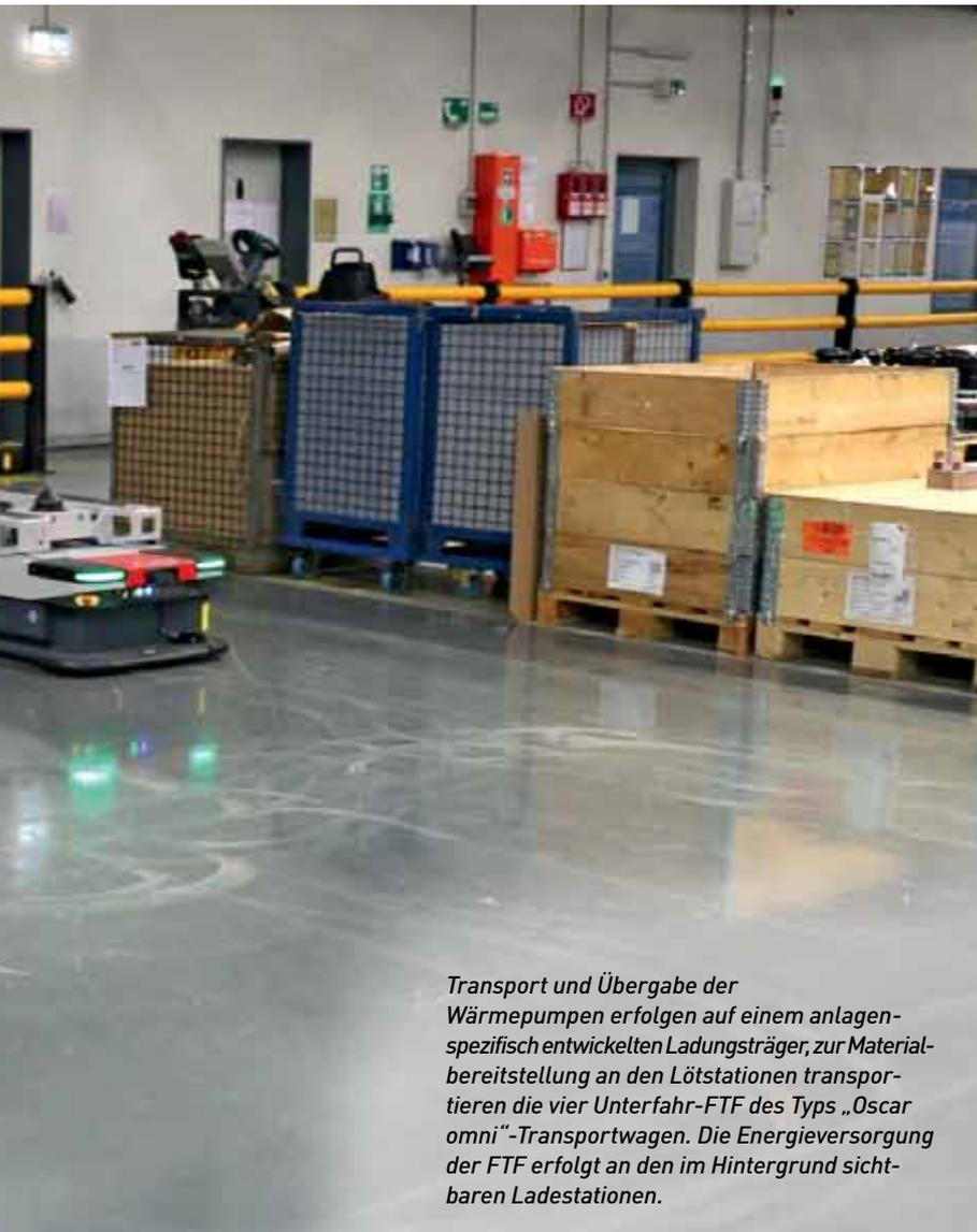
*Transport und Übergabe der Wärmepumpen erfolgen auf einem anlagenspezifisch entwickelten Ladungsträger, zur Materialbereitstellung an den Lötstationen transportieren die vier Unterfahr-FTF des Typs „Oscar omni“-Transportwagen. Die Energieversorgung der FTF erfolgt an den im Hintergrund sichtbaren Ladestationen.*
