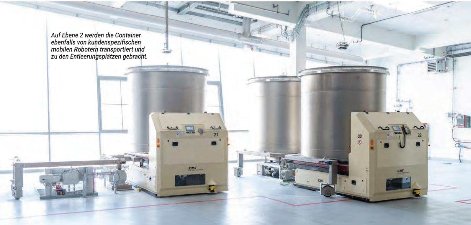
aus Edelstahl mit je 1,5t Fassungsvermögen. Auf der Ebene 0 erfolgen das Dosieren und Mischen der Zutaten. Auf Ebene 2 werden die Behälter entleert und gründlich gereinigt, bevor sie erneut in das Hochregallager gelangen.
