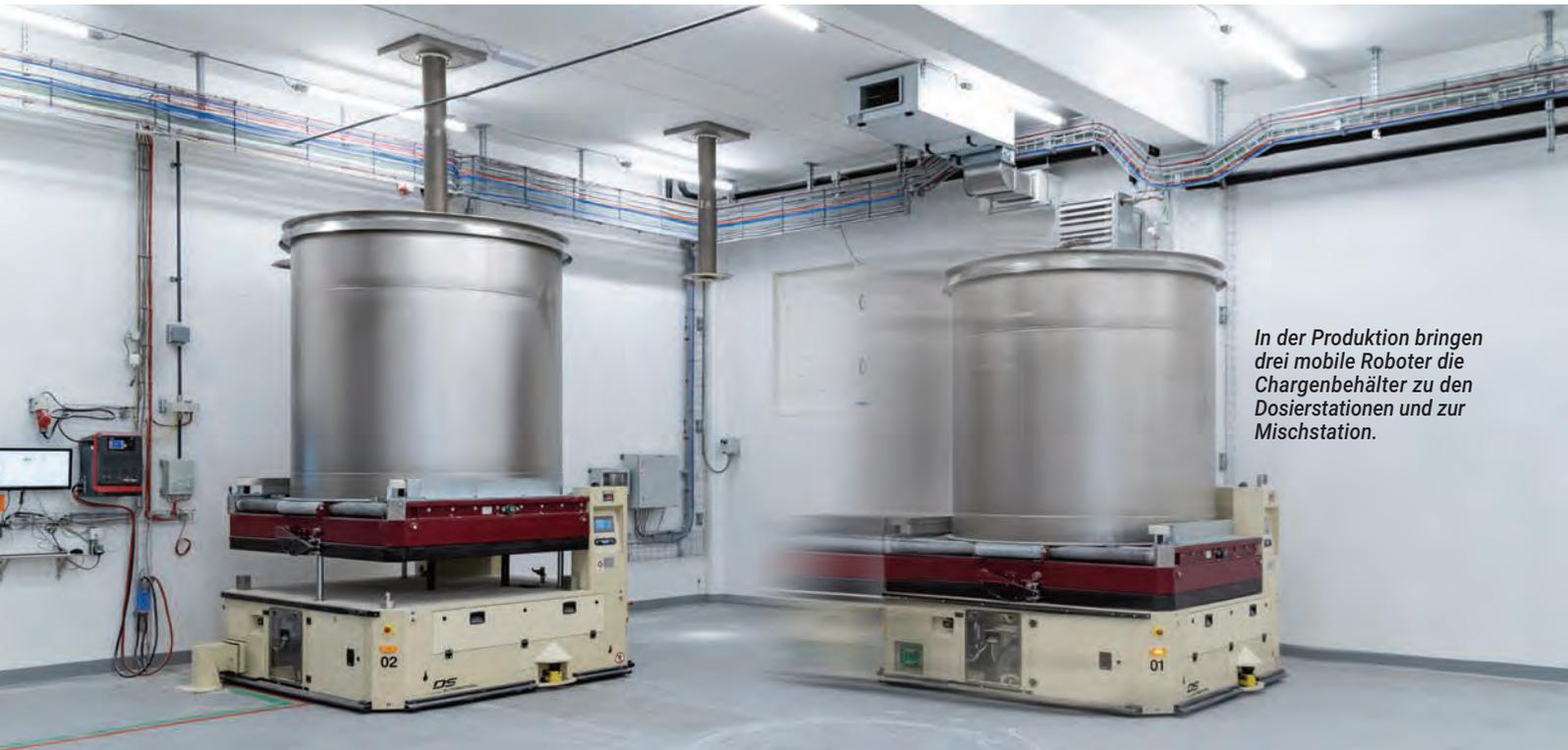
*In der Produktion bringen drei mobile Roboter die Chargenbehälter zu den Dosierstationen und zur Mischstation.*
