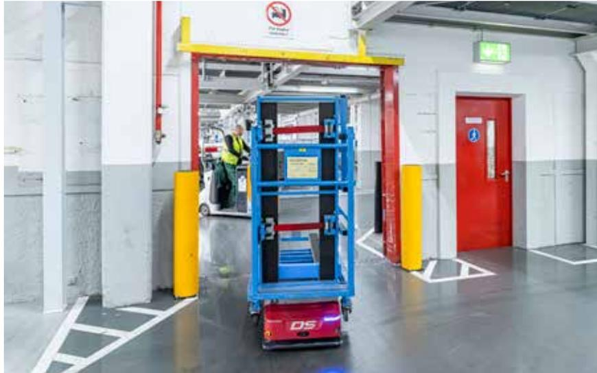
Neben einigen Warnblinkleuchten und einer Ampel ist **auch die Brandmeldezentrale in die Leitsteuerung eingebunden**, da die FTF bei BSH an vier Stellen Brandschutztüre durchfahren.
