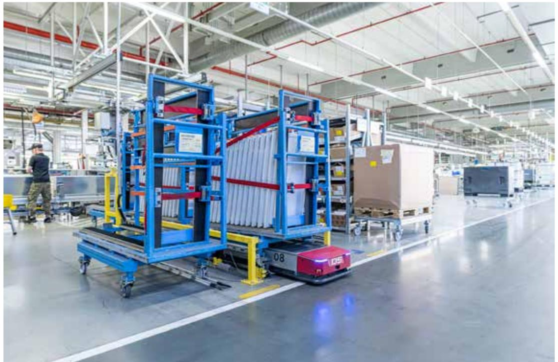
in auftragsbezogener Mischproduktion mit teilweise sehr geringen Losgrößen. Jede Produktionslinie umfasst je eine Türen- und Endmontagelinie, diese sind jedoch örtlich getrennt. Die in jeder Anlage pro Schicht erzeugten rund 600 Türen mussten daher zur „Hochzeit“ mit den Korpusen mehrere hundert Meter zu diesen gebracht werden.
