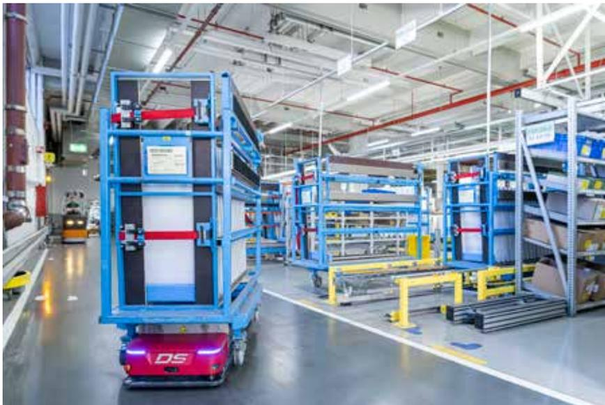
**Der eingesetzte FTF-Typ OSCAR spin** kann am Stand drehen und sehr enge Kurven fahren und so die an den engen Gängen quer zur Fahrtrichtung angeordneten Be- und Entladepositionen optimal bedienen.
