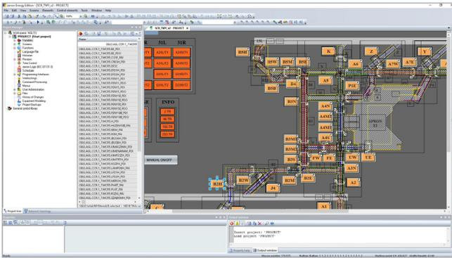
Mittels zenon erstellte die Fachabteilung des Budapester Flughafens ein Leitsystem für die Rollbahnbeleuchtung, das von zwölf redundanten SPS gesteuert wird.
