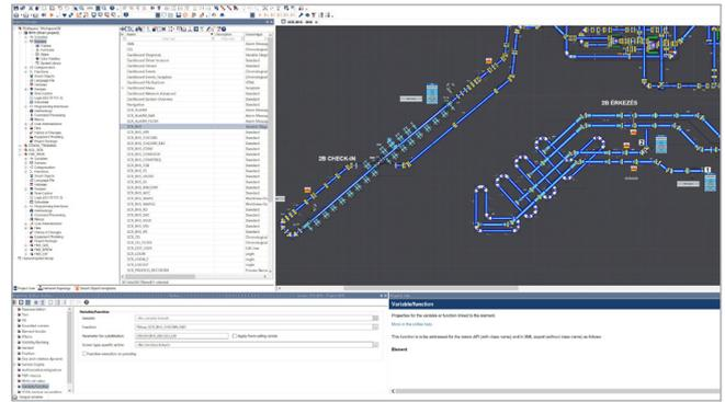
Nur durch Parametrierung erfolgte die Visualisierung des Gepäckfördersystems mit rund 1.000 Förderanlagen innerhalb von zwei Wochen.
