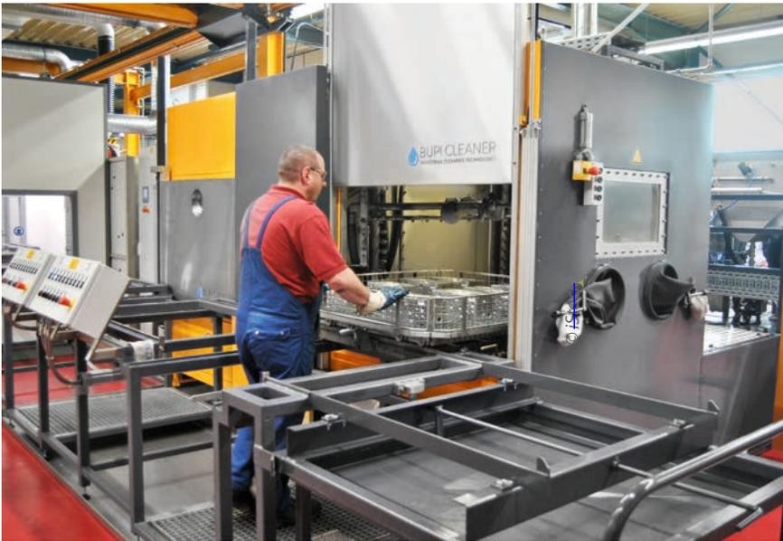
Eine Rollenbatterie verbindet die Zweibad-Spritzreinigungsanlage (vorne) mit dem Vakuumtrockner und zwei geschlossenen Handarbeitsplätzen
