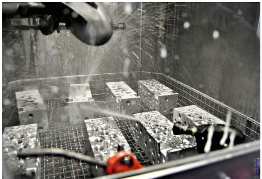
Die Reinigungsanlage ist mit einer Hochdruck-Lanze für bis zu 250 Bar Spritzdruck ausgestattet
