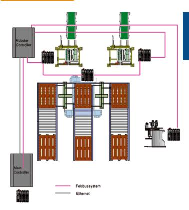
Typische Anordnung einer Post-Print-Anlage: Schneidestationen (rechts), Fördertechnik und Kreuzleger sowie Palettierer (oben) sind mit X20 Schnittstellenmodulen ausgestattet und über DeviceNET als Feldbus verbunden.
