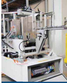
Die ca. 400 I/O Punkte in einer Palettierzelle werden mittels dezentralem X20 System gesteuert, das für eine deutliche Reduktion des Verkabelungsaufwands sorgt.
