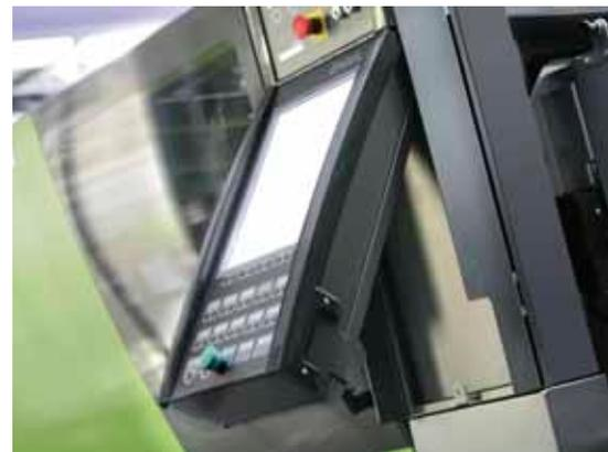
Die Kombination aus Touch-Screen-Technik und diskreten Tasten bietet besten Bedienkomfort.
