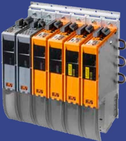
Hochdynamische Servoverstärker der ACOPOS Familie, die in Kombination mit Synchron-, Asynchron-, Linear-, Servo-, Schrittmotor oder Hydraulik zu betreiben sind, bilden die Basis für innovative Antriebstechnik. Standardisierte Softwarebausteine sorgen für ein durchgängiges Antriebskonzept von 20W bis 120kW.
