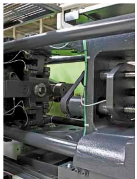
Minimale Stellfläche und maximale Energie-Effizienz dank State of the Art Technologie von B&R: Das ACOPOSmulti Antriebssystem für die Hochleistungsmotoren konnte direkt an der Maschine untergebracht werden und liefert die Bremsenergie zurück ins Netz.
