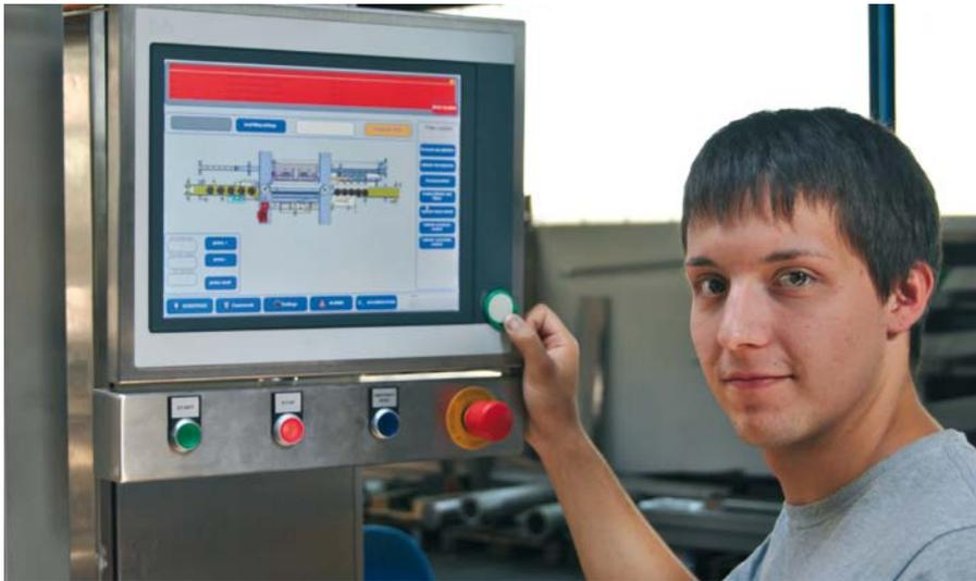
»Die Steuerung läuft unter dem B&R-Betriebssystem Automation Runtime auf einem Power Panel 500 in Edelstahl-Ausführung mit Transponder-Benutzeranmeldung.« Stephan Holz, Elektronik-Programmierer bei AMS.
