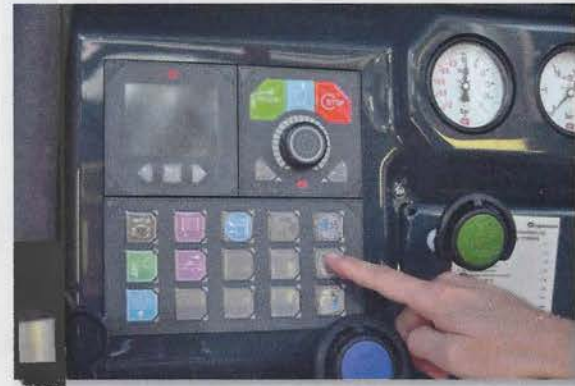
Geräte von B&R für die Pumpen-Hauptbedienung eines Rosenbauer-Tanklöschfahrzeugs mit Hauptanzeige und Mengensteuerung in der oberen Reihe. Die griffgünstigen Tasten sind auch mit Handschuhen bei großer Hitze oder Kälte leicht und sicher zu bedienen.
