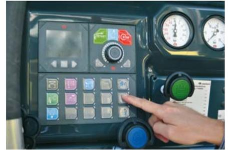
Links unten: Geräte von B&R für die Pumpen-Hauptbedienung eines Rosenbauer-Tanklöschfahrzeuges mit Hauptanzeige und Mengensteuerung in der oberen Reihe. Die griffgünstigen Tasten sind auch mit Handschuhen bei großer Hitze oder Kälte leicht und sicher zu bedienen.
