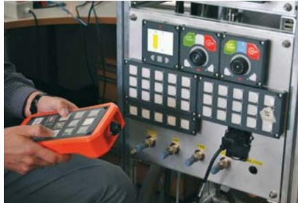
Rechts unten: Die Softwareentwicklung als eine der Kernkompetenzen von Rosenbauer ist ebenso am Hauptstandort Leonding konzentriert wie Elektroplanung, Prototypenbau und Vorserienfertigung. Im Labor wird das logische Zusammenspiel der modularen Visualisierungs- und Bediengeräte von B&R getestet.
