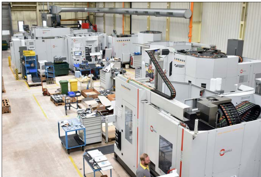
Kernstück der hoch modernen Fertigung ist eine Anordnung mehrerer 5-Achs-Bearbeitungszentren mit Regalspeichermodule und einer Roboter-Automatisierungslösung. Foto: P. Kemptner
