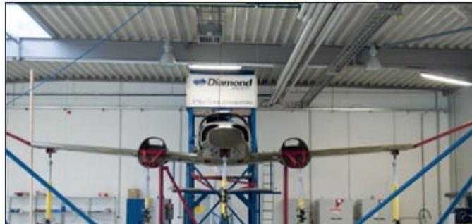
In Belastungstests am Prüfstand erfolgt die Verifizierung der Simulationsergebnisse für die Zulassung bei der Agentur der Europäischen Union für Flugsicherheit (European Union Aviation Safety Agency; EASA).
